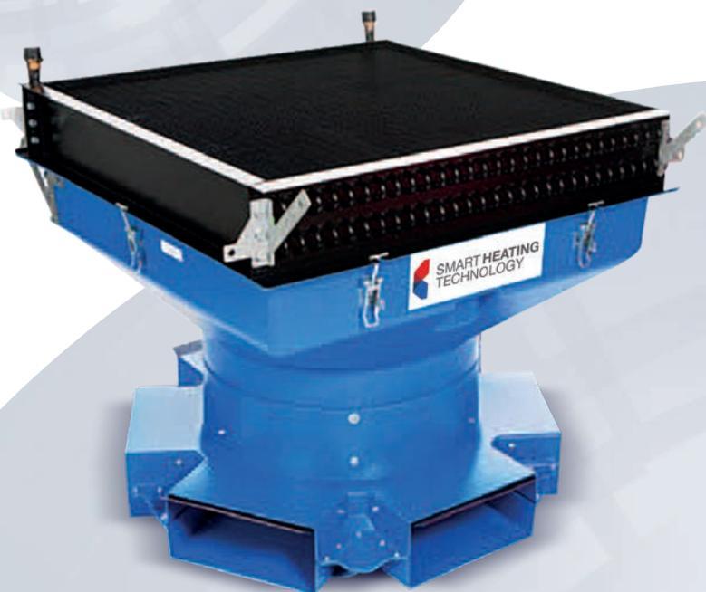
Una unidad de distribución de aire única los Calentadores De Aire 360° SMART unidad consisten en el alto transformador de calor de eficacia, el abanico axial y un dispositivo de distribución único diseñado. El agua caliente es suministrada de una caldera externa y pasa el transformador de calor. El abanico aspira el aire de dentro del edificio por el transformador de calor y empuja el aire caliente igualmente por las 6 salidas de aire.
